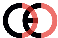
Falsk CE-mærke (for tæt på hinanden)
